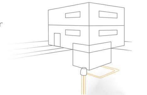
Das Einzigartige an diesem System ist die ständige Regeneration des Erdreiches bei Stillstandzeiten der Wärmepumpe durch Selbstzirkulation des Arbeitsmittels CO<sub>2</sub>.
